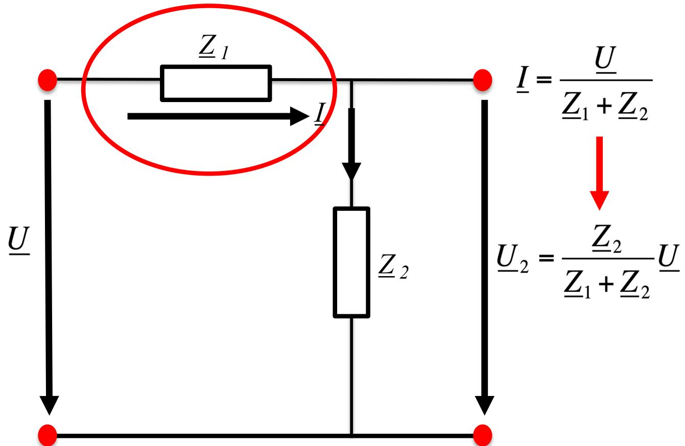
Commentaire: la tension partielle aux bornes de l'autre impédance est:  $\underline{U}_1 = \frac{\underline{Z}_1}{\underline{Z}_1 + \underline{Z}_2} \underline{U}$
